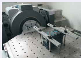
Sistema vibração elétrica
